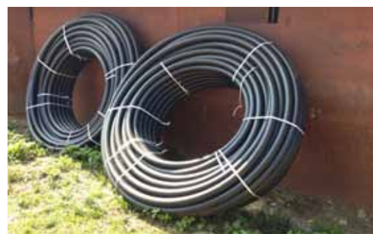
«Эти полиэтиленовые трубы целесообразно проложить между участков»
